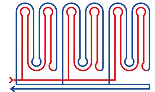
Bei der Montage von mehreren Wandheizmodulen ist die Parallelschaltung erforderlich. Damit können auch größere Räume leistungsfähig bedient werden.
